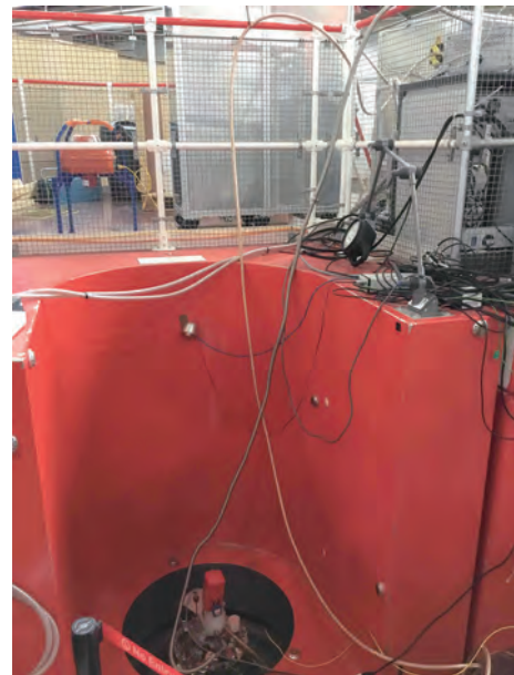
図1 ラザフォード研究所の中性子分光器Merlinにおける強磁場実験のセットアップ。手前がクライオスタット、奥の銀色の箱がコンデンサ電源。
