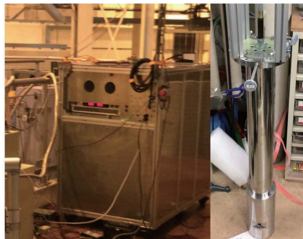
図2 今回の実験に用いた持ち運び型のパルス磁場電源と40Tの中性子コイルインサート. これらを海外の中性子施設まで空輸して実験を行った.
